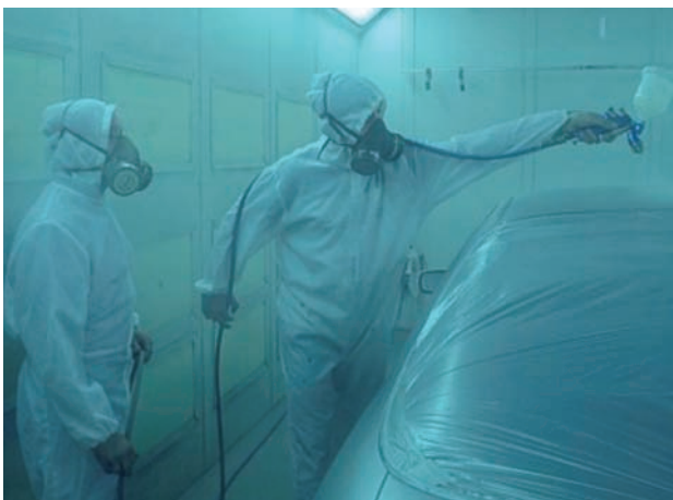
Figura 5 - Uno de los procesos donde es normal la formación de nieblas es en pintura por proyección. Si esta pintura o sus disolventes son inflamables, se podría formar una ATEX.
