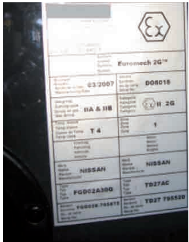
Figura 39 - Marcado de equipos no eléctricos.
