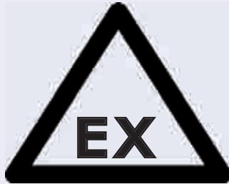
Zona con riesgos de atmósferas explosivas
