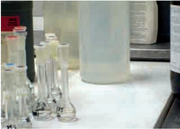
Figura 11 - El uso de pequeñas cantidades de sustancias inflamables con las debidas precauciones no formará atmósfera explosiva en cantidades peligrosas.
