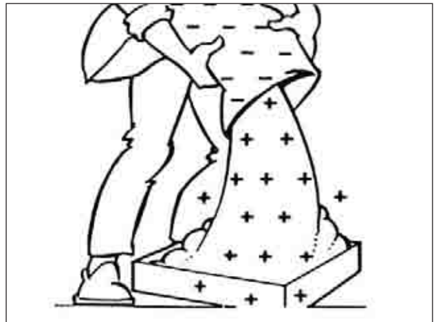
Figura 6 - En los procesos de ensacado, trasvase, transporte, etc. de polvos inflamables se pueden formar ATEX.
