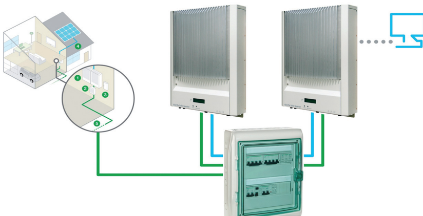
Figura 2.3. Ejemplo de autoconsumo para instalación residencial
