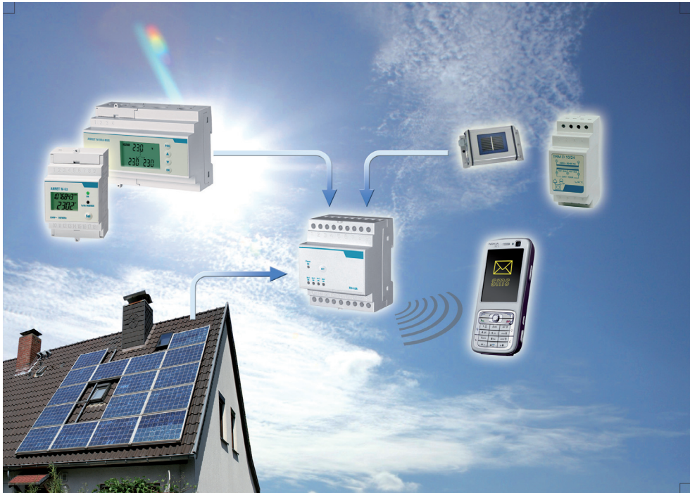
Figura 2.2. Monitorización de pequeña instalación fotovoltaica
